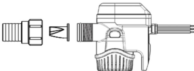
Rimuovere, pulire ed ispezionare periodicamente la pompa di sentina, la valvola di sfianto e lo spazio circostante per rilevare danni e presenza di residui che potrebbero ridurre le prestazioni della pompa.
