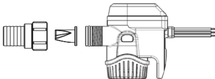
Enlever, nettoyer et inspecter périodiquement la pompe d'assèchement, le clapet antiretour et la zone environnante pour être certain qu'il n'y ait aucun dommage ou débris pouvant réduire le rendement de la pompe.
