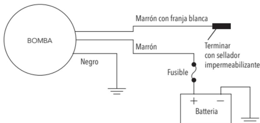
**Para la bomba de 12 voltios:** Voltaje mínimo requerido de 10,5 voltios.
