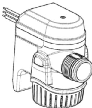
**Bästa praxis:** Använd två rostfria slangklämmor för att fästa slangen på slangkopplingen.
